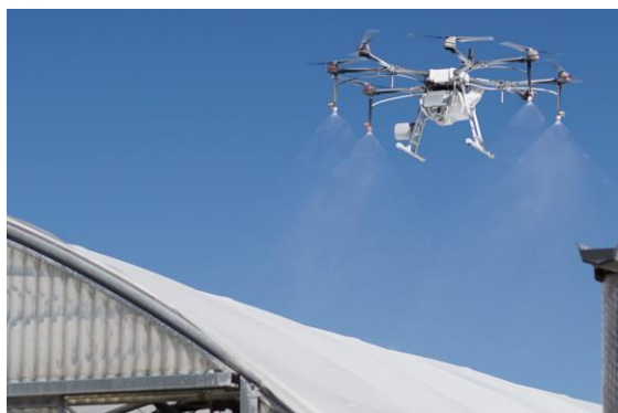
Bild 1 und 2: Die WhiteDrone in Aktion. Links, die Drohne in der Luft vor der Applikation der Schattierfarbe über einem Folientunnel und rechts während der Applikation, wobei ein Teil der Fläche fertig schattiert wurde.
